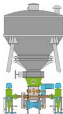
Silo con sistema di dosaggio doppio.
