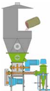
Sistema di dosaggio con carico manuale.
